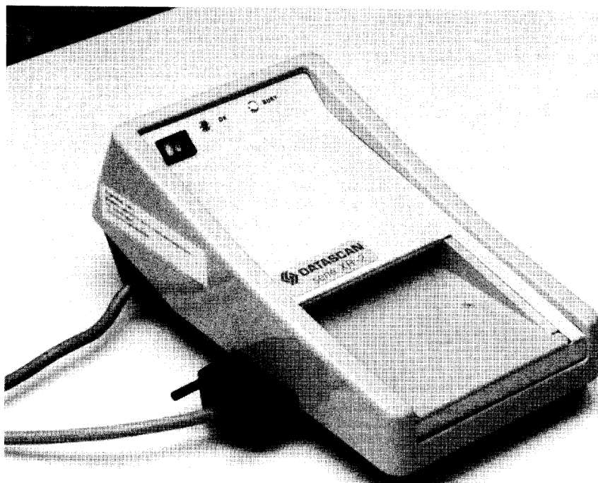
Fig.1. Leesapparaat voor schrapkaarten die met de hand in de gleuf gestopt moeten worden. Met rollen wordt de kaart verder door het apparaat getrokken.
