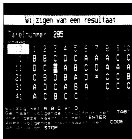
Fig.3. Schermfoto van de editor. Deze kandidaat heeft vraag 13 dubbel beantwoord of niet goed genoeg gegumd. De cursor staat al klaar op die plaats. Even op de kaart kijken en op het toetsenbord kan een A, B, C of D worden getypt. Vraag 27 is ook gegumd en vragen 37 en 46 t/m 50 zijn helemaal niet aangestreept.
